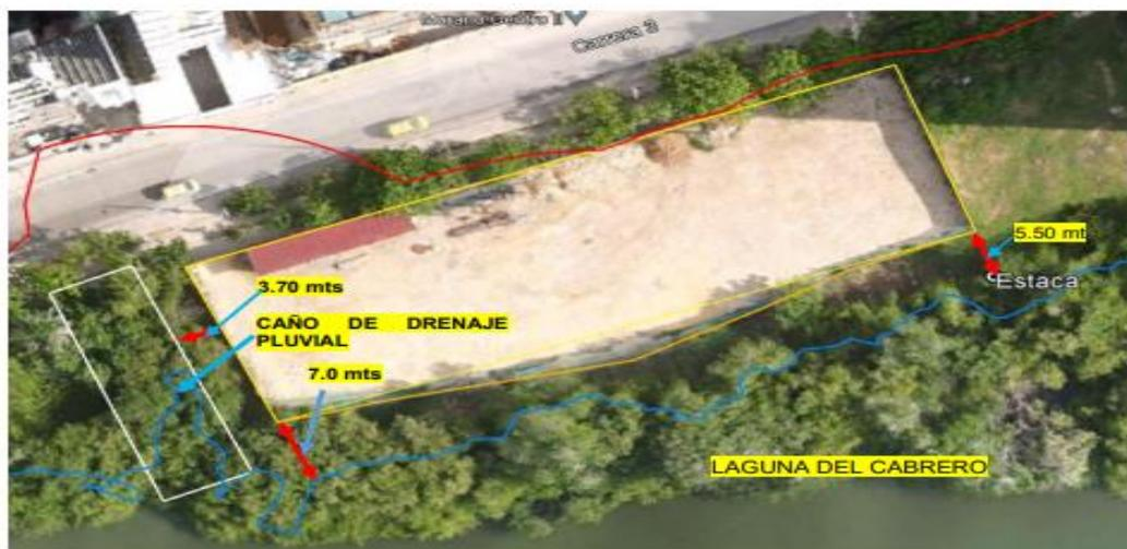
**Figura 1.** Superposición de Ronda Hídrica y zona de implantación del proyecto EDIFICIO VENTO CABRERO. Leyenda: línea blanca: sistema de drenaje; línea amarilla: zona de implantación del proyecto; línea naranja: cerramiento temporal del proyecto; línea roja: faja paralela de La Laguna El Cabrero y; línea azul: cauce permanente de La Laguna El Cabrero, Fuente: EPA Cartagena
