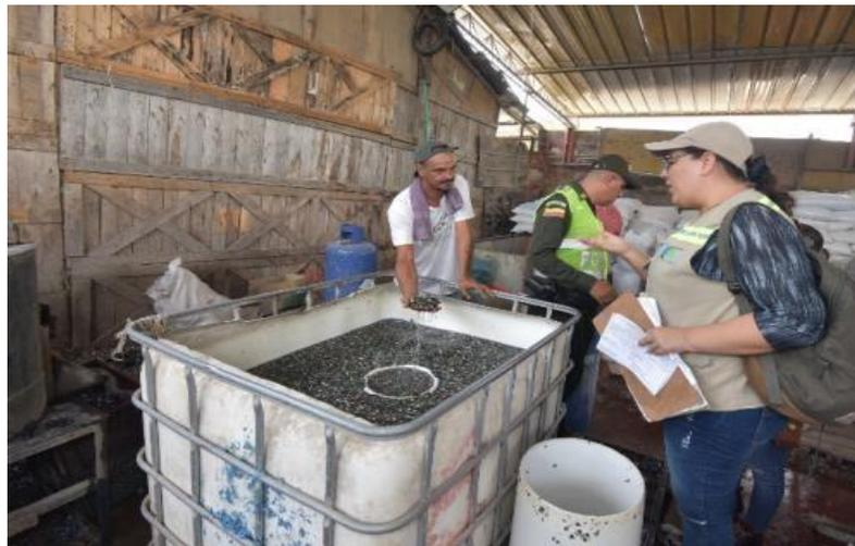
**Figura 4.** Tanque para lavado del triturado plástico. **Fuente: Autores 2023.**
