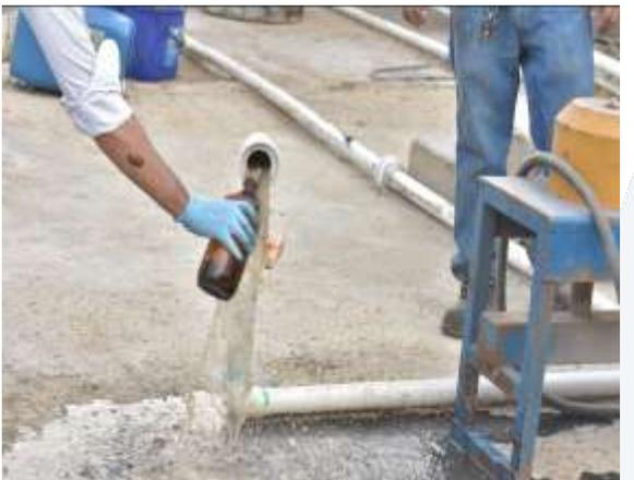
**Imagen 24.** Toma de muestra Laboratorio contratado Labomar a tanque de almacenamiento de aguas de industriales de los clientes
