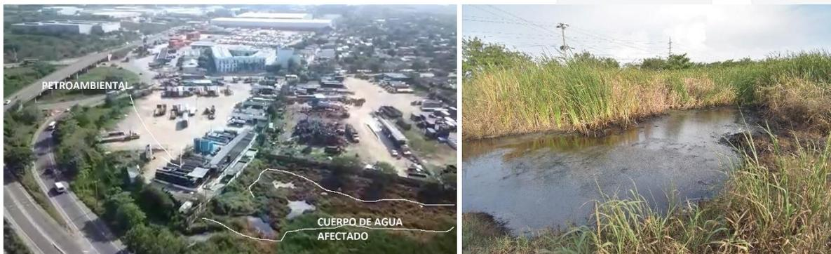
*Imagen 8. Cuerpo de Agua Canal Policarpa 2, Manchas Oscuras en el cuerpo de agua y vegetación con clorosis generalizada y necrosis. Fuente EPA Cartagena.*
