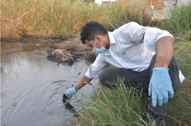
*Imagen 13. Toma de muestra 2. Tomada 20 metros (aprox) aguas abajo del punto de descarga no autorizado. Fuente EPA Cartagena*
