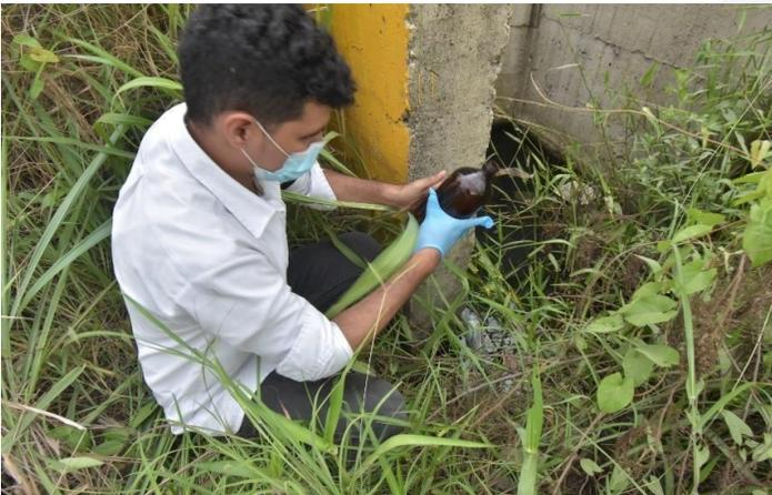
*Imagen 15. Toma de muestra 4. Tomada 50 metros (aprox) aguas arriba del punto de descarga no autorizado. Fuente EPA Cartagena.*
