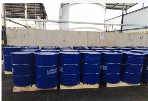
Área temporal de almacenamiento de tambores – trasvasados por isotanques
