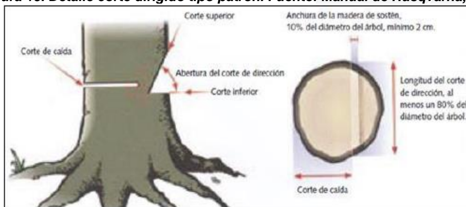
Figura 15. Detalle corte dirigido tipo patrón. Fuente: Manual de Husqvarna, 2000
