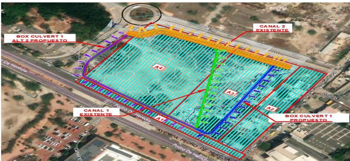
**Figura 11. Áreas de drenaje tributarias a las estructuras hidráulicas existentes en el proyecto.**
