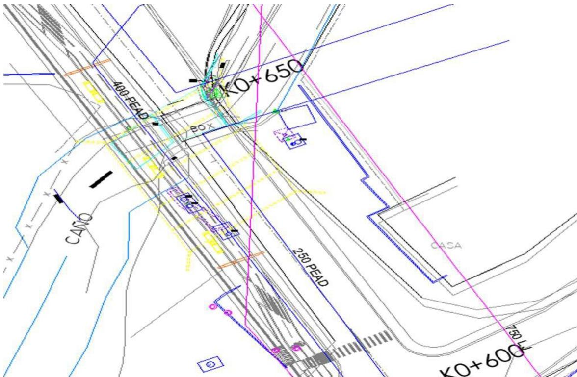
Figura 2. Interferencia con tubería de 1000 mm H.D K0+648
