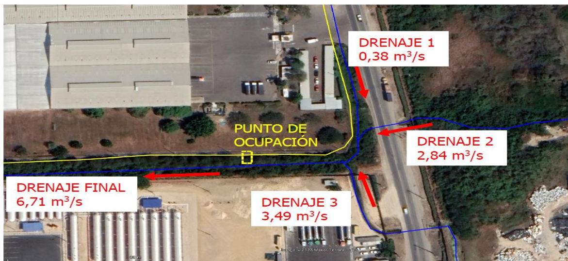
Figura 12. Caudales máximos de los drenajes
