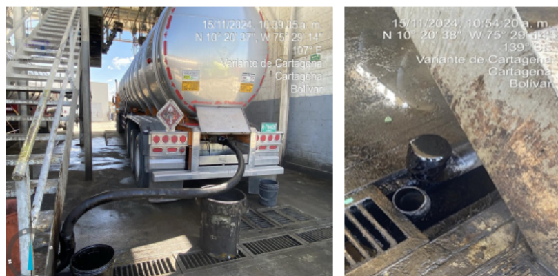
Figura 2. Lavado de carrotanque y conexión de manguera a tubería subterránea.
