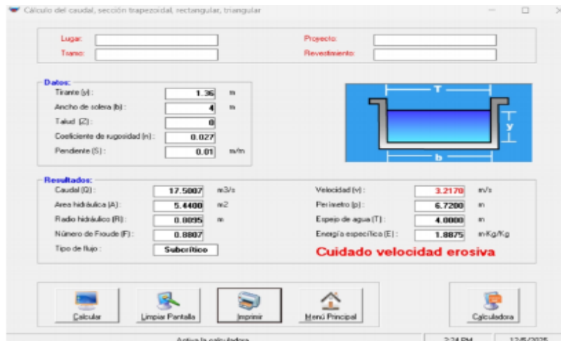
Figura 11. Evaluación de capacidad hidráulica de tramo del canal alameda con sección rectangular
