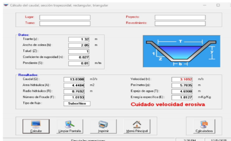
Figura 12. Evaluación de capacidad hidráulica de tramo del canal alameda con sección trapezoidal.
