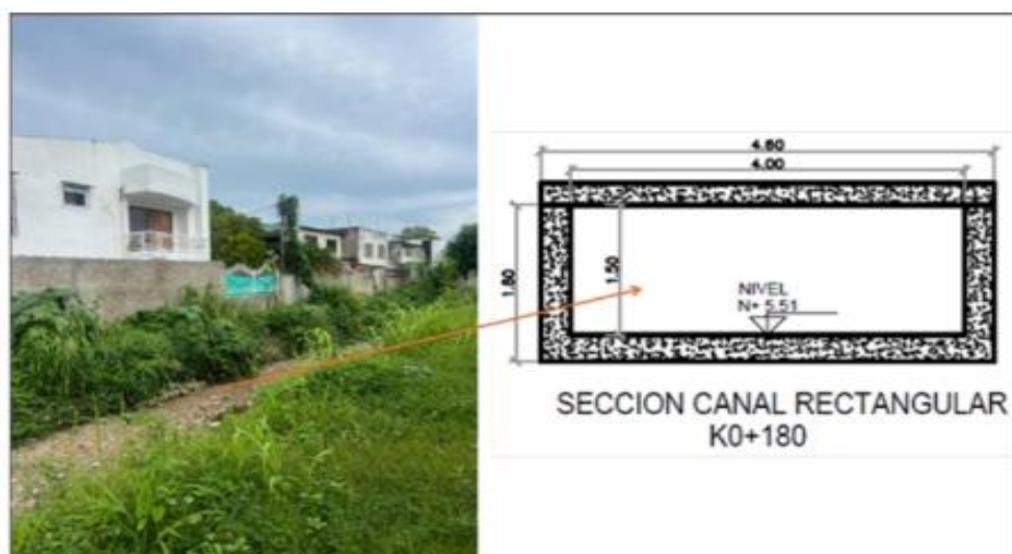
Figura 9. Ocupación con canalización en sección rectangular con tapa.
