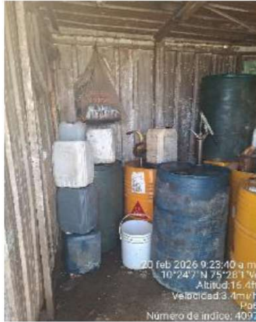
Ilustración 10. Area de almacenamiento de productos químicos, sin contar con caneca para respel.
