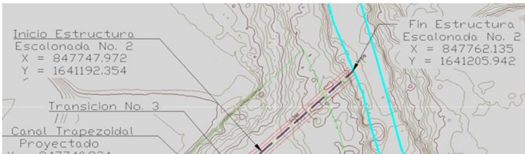
Figura 8. Ubicación estructura escalonada
